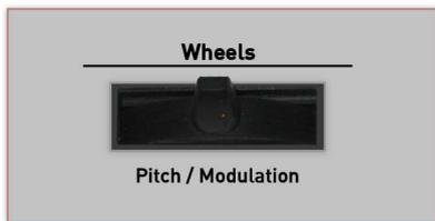
Auf der linken Seite finden Sie den Joystick der für die Tönhöhenveränderung und die Modulation zuständig ist.
