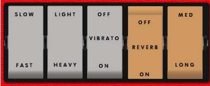
Das Vibrato kann ein- oder ausgeschaltet werden. Weiterhin ist die Vibrato-Geschwindigkeit zwischen schnell (FAST) und Langsam (SLOW), sowie in der Intensität zwischen wenig (LIGHT) und stark (HEAVY) einstellbar.
